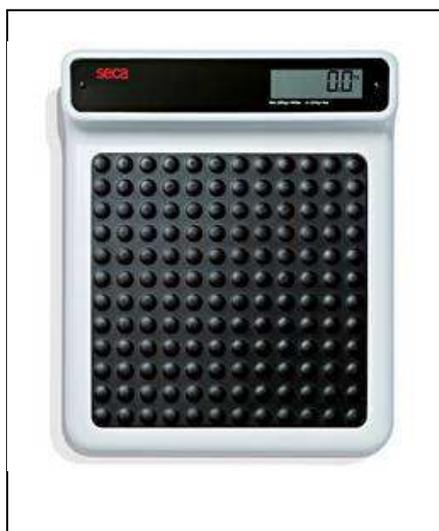
La **balanza** utilizada para medir el peso es el **modelo SECA 770**. Se utilizará un objeto de peso conocido para calibrarlo mensualmente. Peso máximo: 200 Kg. (<https://www.seca-online.com/seca-770.1998.0.html?&L=2&C=es>)
