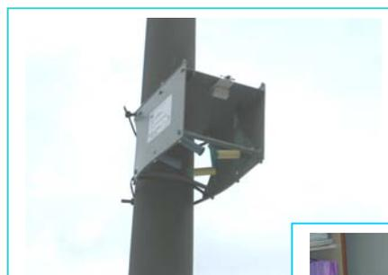
Captadores utilizados para medir gases
