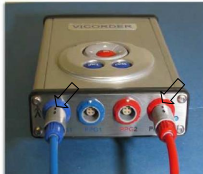
Figura 20. Línea de presión conectada al Vicorder.
